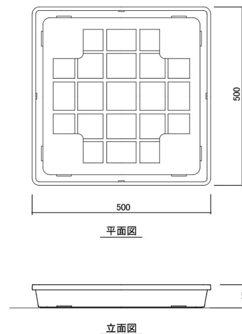
トレー押さえ金物詳細 材質/高耐蝕溶融鍍金鋼板(ZAM材)
