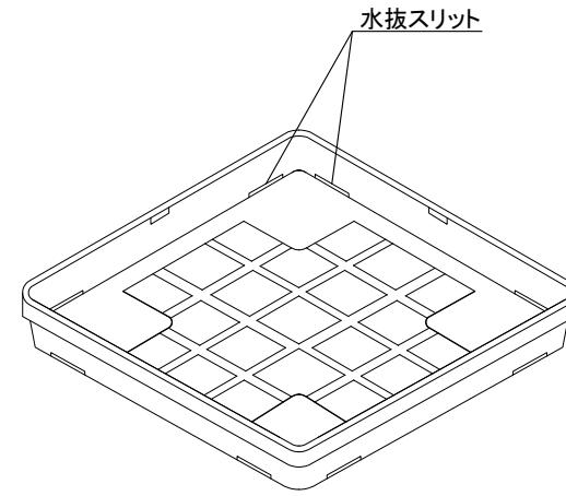
トレー周囲見切り金物詳細 材質/高耐蝕溶融鍍金鋼板(ZAM材)  $t=1.2$
