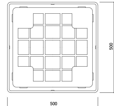
トレー押さえ金物詳細 材質/高耐蝕溶融鍍金鋼板(ZAM材)
